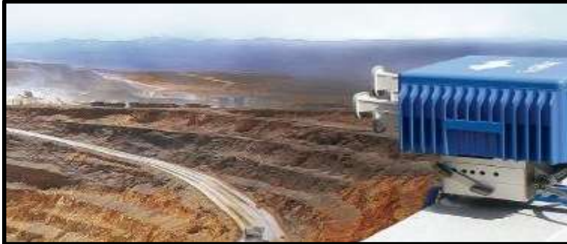
Fig. 13 Vista Radar monitoreando Pared Mina a Rajo Abierto
